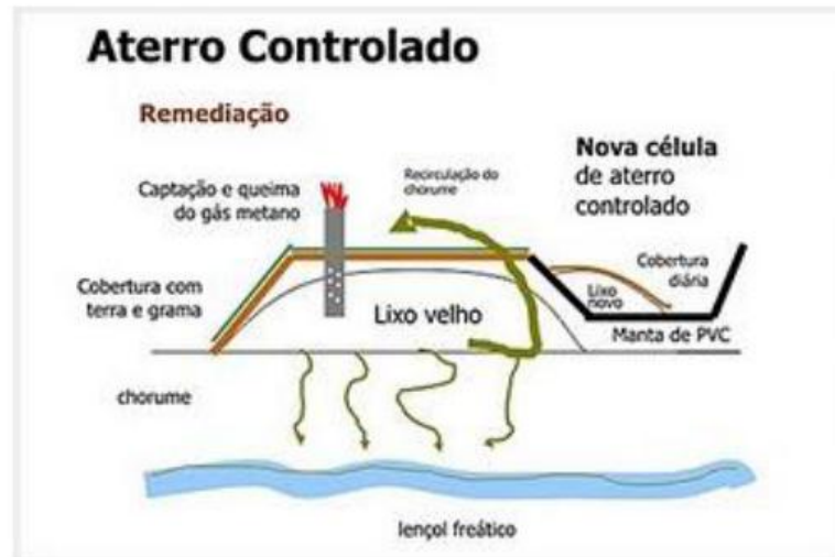
Figura 1 – Funcionamento de um aterro controlado
