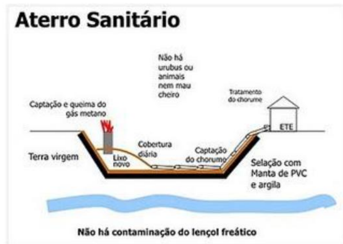
Figura 2 – Funcionamento de um aterro sanitário
